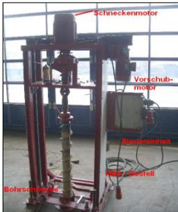
Prototyp der mobilen Hohlbohrschnecke und Bauteil-Komponenten
