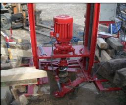
Feldversuch zur Funktionsüberprüfung und Bemessung der Drehkräfte
