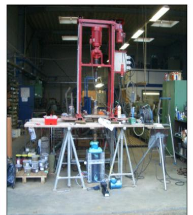
Versuchsaufbau zur Entnahme von BTEX-haltigen Gasen und Ermittlung von Beprobungsverlusten
