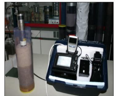
Versuchsaufbauten mit Mikro-Kamera sowie Vor-Ort-Mess-Techniken an Bodensäulen im Labor
