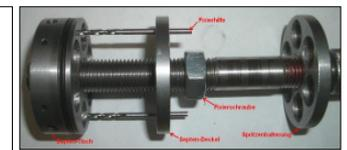
Detailansicht des Beprobungssystems mit Nennung der einzelnen Bestandteile des Systems
