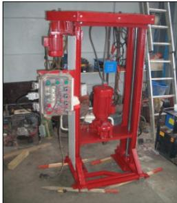
Rahmenkonstruktion der mobilen Hohlbohrschnecke
